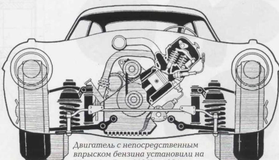
мощью насоса, приводимого от коленвала эксцентриковым механизмом. Двигатели Gordon-Brillie имели весьма совершенную систему принудительной подачи топлива во впускной трубопровод специальным лопастным колесом, точно отмеряющим дозы подачи. В моторах Wilem для этих целей применялись диафрагменные насосы.
